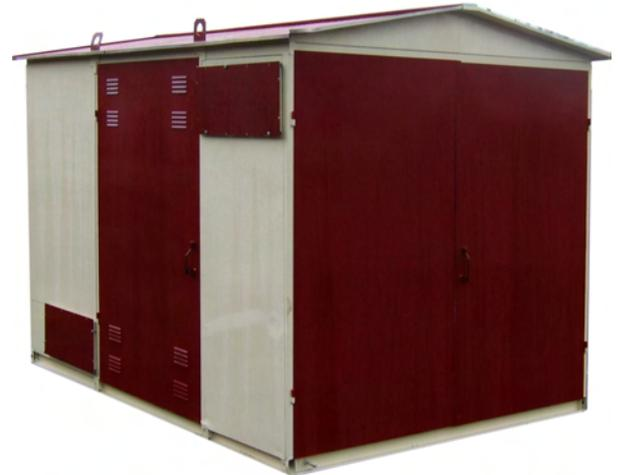
КТПГС поставляются в металлической кабине (2КТПГС - в двух кабинах), с вмонтированным в неё силовым трансформатором, шкафами УВН, РУНН, шкафом уличного освещения (по заказу). По желанию заказчика в качестве шкафов УВН и РУНН могут устанавливаться ячейки КСО и панели ЩО, габариты подстанции при этом уточняются при разработке.
